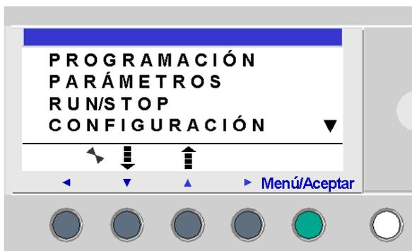
**NOTA:** La pantalla LCD se ilumina durante 30 segundos cuando se pulsa una tecla del panel frontal.
